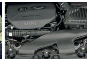
Motor 1.5 TwinPower Turbo de 136 cv.
