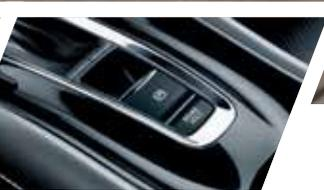
Freio de estacionamento eletrônico com função Brake Hold
